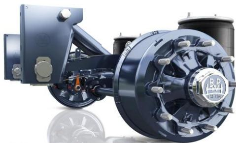
2.2.1. 3-х осный осевой агрегат **BPW Heavy Duty (Германия)**, барабанные тормоза, усиленное исполнение сечение стенки 15 мм, квадратная ось более устойчива к скручиванию, которые возникают на дорогах России и СНГ имеющих боковой уклон. Допустимая нагрузка на каждую ось 9000 кг;
